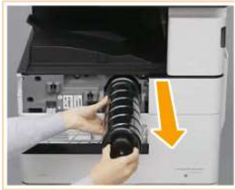
Obrázek 5: Ukázka výměny tonerové kazety na MFP Canon ImageRunner, www.alza.cz
